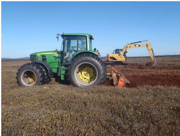
Cosechadora y trituradora de plantas en el sitio del donador. Fuente: Premier Tech
